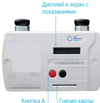
Дисплей включается нажатием кнопки А или после ввода карты счетчика газа. Информация на последнем выбранном дисплее остается видимой в течение 30 секунд. Счетчик имеет два информационных экрана:
